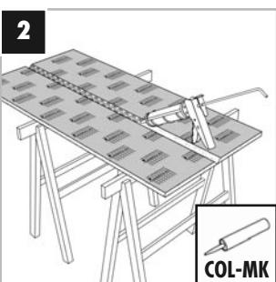
**[DE] Schritt 2 – Kleberauftrag, Nutfräzung**
